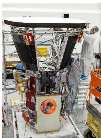
Lancée en 2018 par la NASA, cette sonde a la taille et la masse d'une petite voiture. À sa distance la plus proche du Soleil, le rayonnement est presque 500 fois plus intense que sur Terre, ce qui porterait la sonde à environ 1400° en l'absence de protection, un défi technologique relevé grâce à un bouclier thermique de nouvelle génération en composite de carbone de 11,5 cm d'épaisseur.
