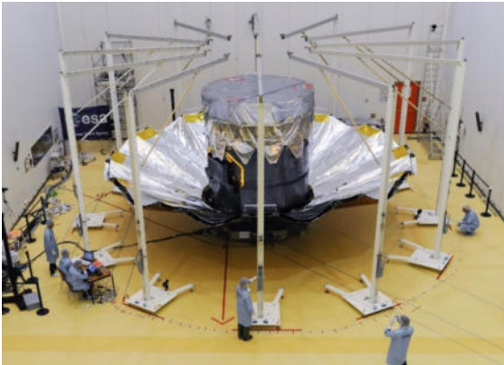
Octobre 2013 : test du déploiement du bouclier du satellite Gaia à Kourou (Guyane française) avant son lancement. Crédits : ESA-M. Pedoussaut.
