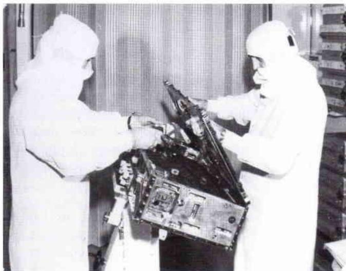
Il importait donc de doter notre ensemble d'essai de salles appropriées où l'atmosphère conditionnée et traitée permettait d'obtenir des niveaux d'empoussièrement adéquats. Sous la halle étaient installées 5 salles "propres" couvrant ainsi plus d'un tiers de la superficie utile totale.
