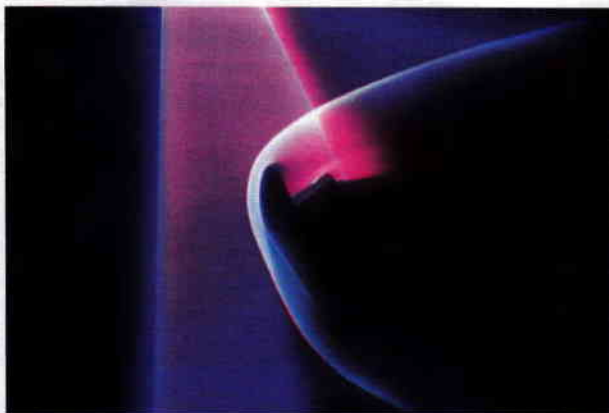
Test d'une capsule martienne en soufflerie hypersonique à Meudon, à Mach 10, soit 1,5 km/s à la 1 re d'écoulement de 50 °K = -223 °C
