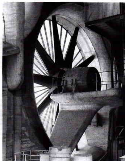
Vue rapprochée d'une hélice de la Grande Soufflerie de Chalats-Meudon (Cliché Philippe ARAULT / Inventaire général)
