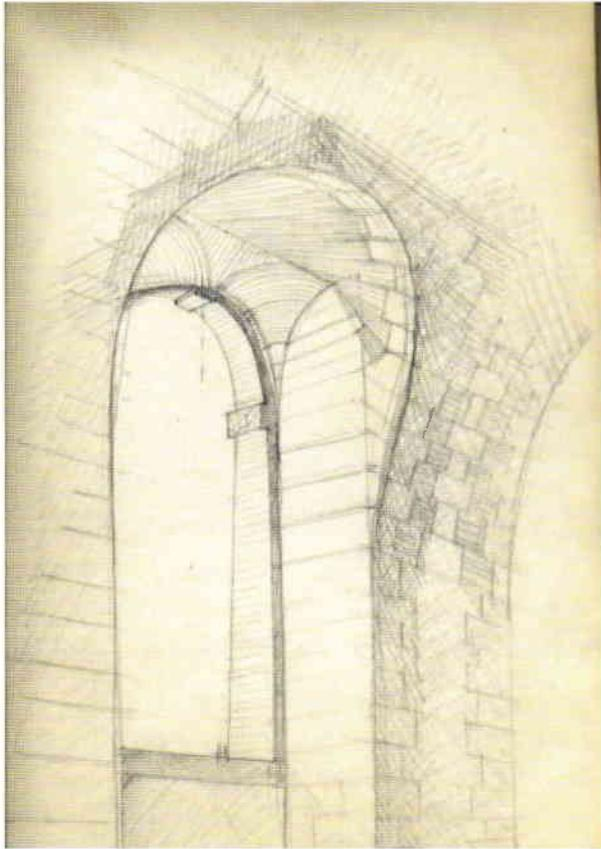
Fig. 6 – Arrière-voussures des baies vitrées (dessin de l'auteur et photo J.-B. Delaporte).
