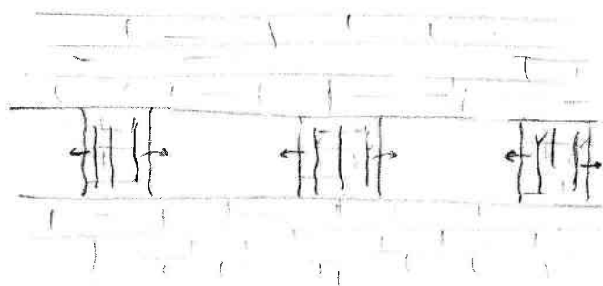
Schéma 2a : amorce de ruptures des piliers (en extension ou cisaillement) Ex : mines de sel de Louisiane
