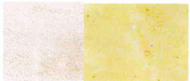
*Fig. 4 - La pierre de Fontvieille : calcaire à grains fins bicolore.*
