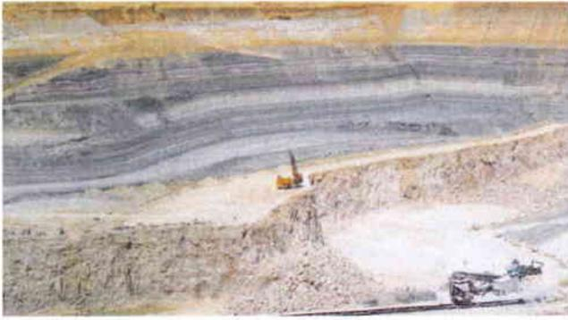
**Fig. 15 - Front de taille de la carrière de Cormeilles en Parisis ouverte dans des alternances de couches de gypse, en clair sur la photo et de lits argileux en gris-bleu.**
